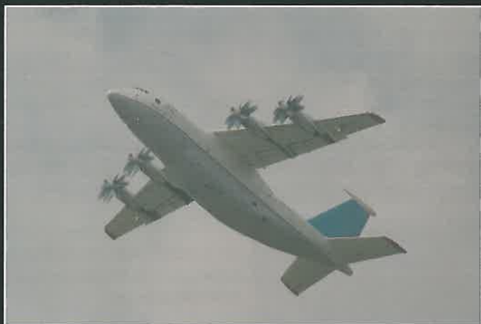
An-70 under stigning. Flygplanet är försett med motroterande propellrar.
