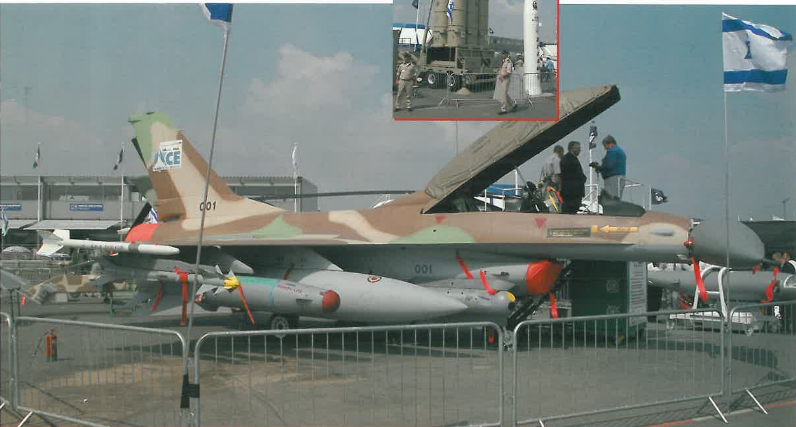
Israeliska flygvapnet planerar att modifiera sina F-16 med ett uppgraderingspaket benämnt ACE (Avionics Capabilities Enhancement). Den modifierade F-16B som visades på mässan var försedd med jaktrobot Python 4, attackrobot Popeye II, målnmättningskapsel Litening samt två stora extratankar (2200 liter/st).
