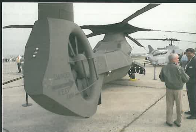
RAH-66 sedd snett bakifrån. Notera den inkaplade stjärtrotorn. Avgaserna pressas blandat med kylsluft ut nedåt längs helikopterns kroppssidor.
